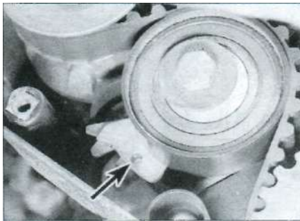
Рис. 7.8,а. Заведите выколотку в отверстие (указано стрелкой)
