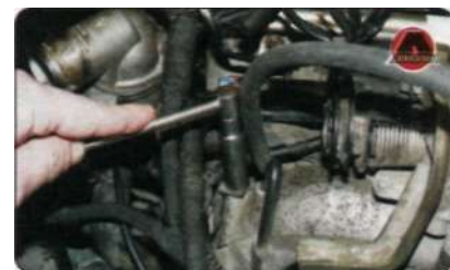
10. Отвернуть болт крепления и отсоединить держатель жгута проводов от впускного коллектора.
