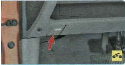
31 - рукоятка привода замка капота (см. «Капот», с. 27).
