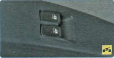
33 - блок управления стеклоподъемниками. Расположен в подлокотнике двери водителя (см. «Стеклоподъемники», с. 22).
