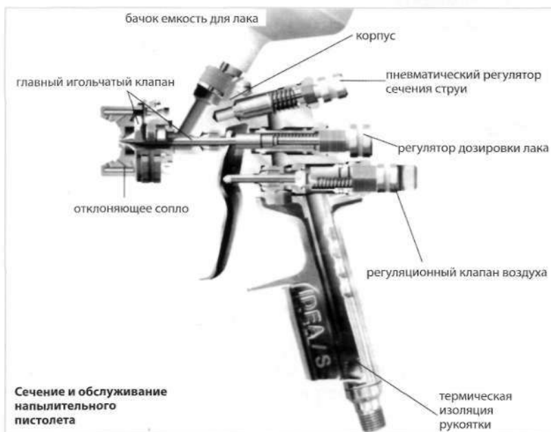
Фото. Строеие лакокрасочного пистолета. (SATA)
