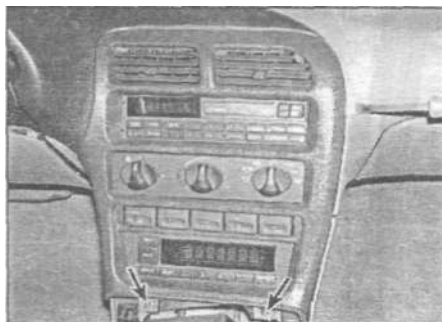
Рис. 28.12. Выверните винты (показаны стрелками) и снимите центральную часть лицевой панели
