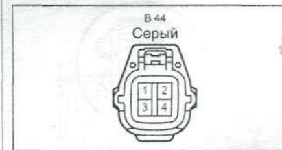
В 44. Дополнительный разъем (звуковой сигнал TVSS)
