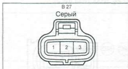
В 27. Вентилятор охлаждения ECU № 1
