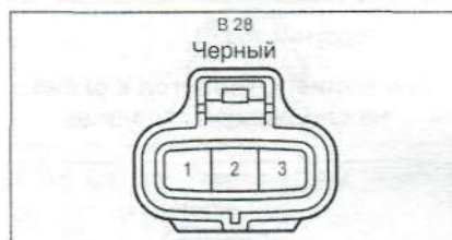
В 28. Вентилятор охлаждения ECU № 2
