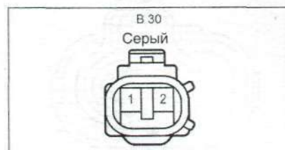
В 30. Переключатель индикатора топливного фильтра
