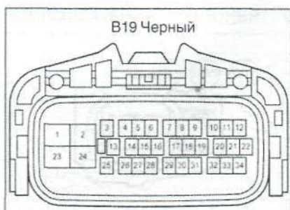
В 19. Блокировка пробуксовывания (с актуатором)
