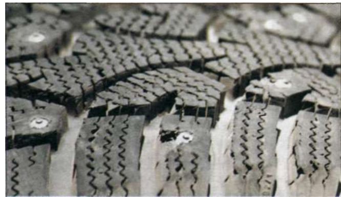
Последствия летней эксплуатации зимней ошипованной шины: шашки протектора повреждены, шипы — на грани выпадения
