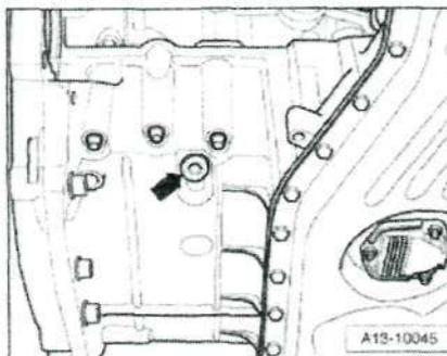
Ввернуть фиксирующий болт -3242- в отверстие (20 Нм), при необходимости для полного центрирования болта коленвал -1- поворачивать немного вперед-назад.
