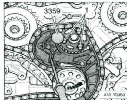
Для расфиксирования натяжителя цепи извлечь сверло из отверстия. Нажать отверткой -в направлении стрелки- на планку успокоителя натяжителя цепи и одновременно затянуть болты -1- звездочки цепного привода. Извлечь штифт топливного насоса дизельного двигателя -3359- из балансирующего вала. Установка в обратном порядке. Установить крышки цепей привода. В а/м с МКП установить двухмассовый маховик. В а/м с КП multitronic установить маховик. В а/м с АКП установить ведомый диск. Залить масло.
