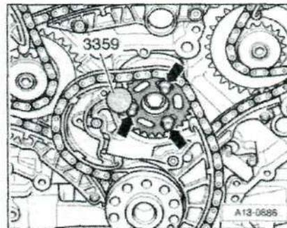
Для защиты от порезов обмотать конец и режущие кромки сверла 3,3 мм изоляционной лентой. Переместить планку успокоителя натяжителя приводной цепи -в направлении стрелки- и зафиксировать натяжитель цепи сверлом 3,3 мм -1-. Отвернуть болты -2-, -4- и -5- и снять натяжитель цепи, звездочку -3- балансирующего вала, а также цепь.
