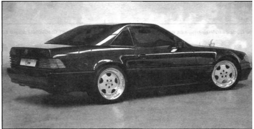
Показанные здесь дымчатые тонированные стекла от фирмы "Pentago Auto Tint" не только отлично смотрятся, но и позволяют улучшить весовые характеристики автомобиля за счёт замены штатных боковых стёкол на поликарбонатные.
