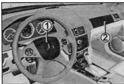
028б Фронтальная подушка безопасности водителя (1) и переднего пассажира (2)
