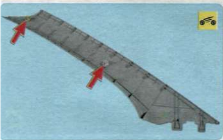
2. ...и, преодолевая сопротивление пистонов крепления, снимите облицовку.
