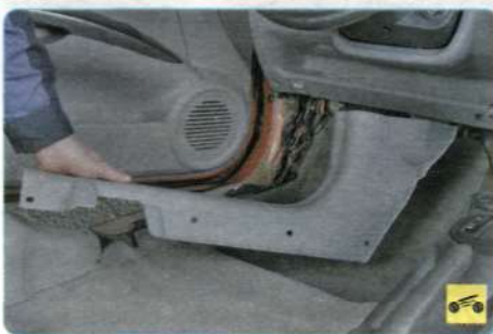
5. Снимите переднюю облицовку порога,
