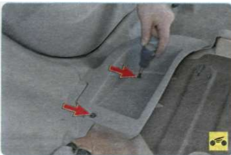
6. Для снятия задней облицовки порога выверните два винта крепления.
