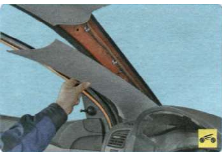
2. ...и, преодолевая сопротивление пистонов крепления, снимите облицовку.
