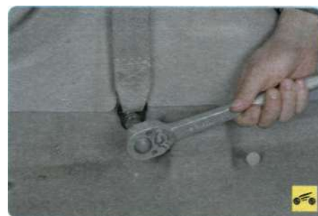
10. Для снятия нижней облицовки центральной стойки кузова выверните болт нижнего крепления ремня безопасности...
