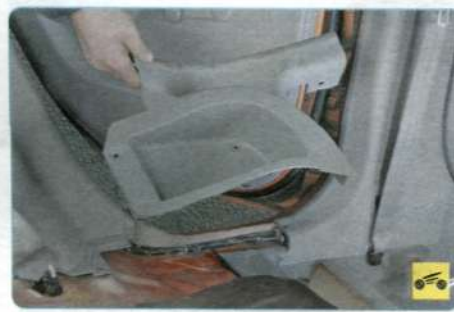
9. Снимите заднюю облицовку порога.
