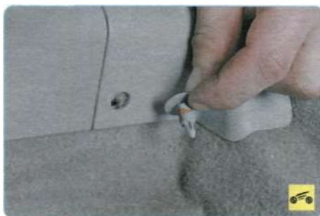
4. ...и извлеките пистоны крепления облицовки.
