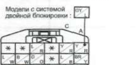
0914-103 ЭЛЕКТРОПРИВОД И ВЫКЛЮЧАТЕЛЬ БЛОКИРОВКИ ЗАМКА ПЕРЕДНЕЙ ЛЕВОЙ ДВЕРИ
