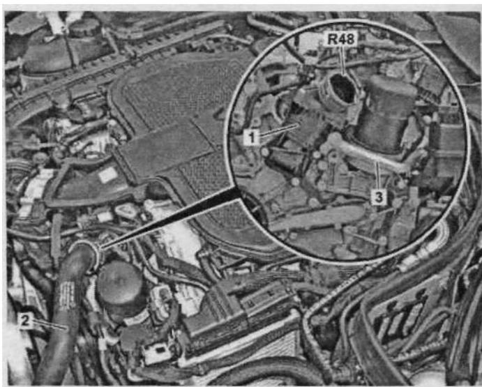
Уплотнительный элемент штуцерного узла подключения линии (3) подлежит замене в обязательном порядке!
