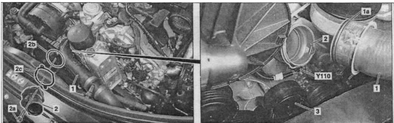
4.1 Детали установки 3-дискового термостата (Y110) на двигателях 272
